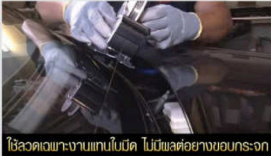
เครื่องมือออกแบบมาพิเศษ ไม่พลต้อตัวถังรถ
